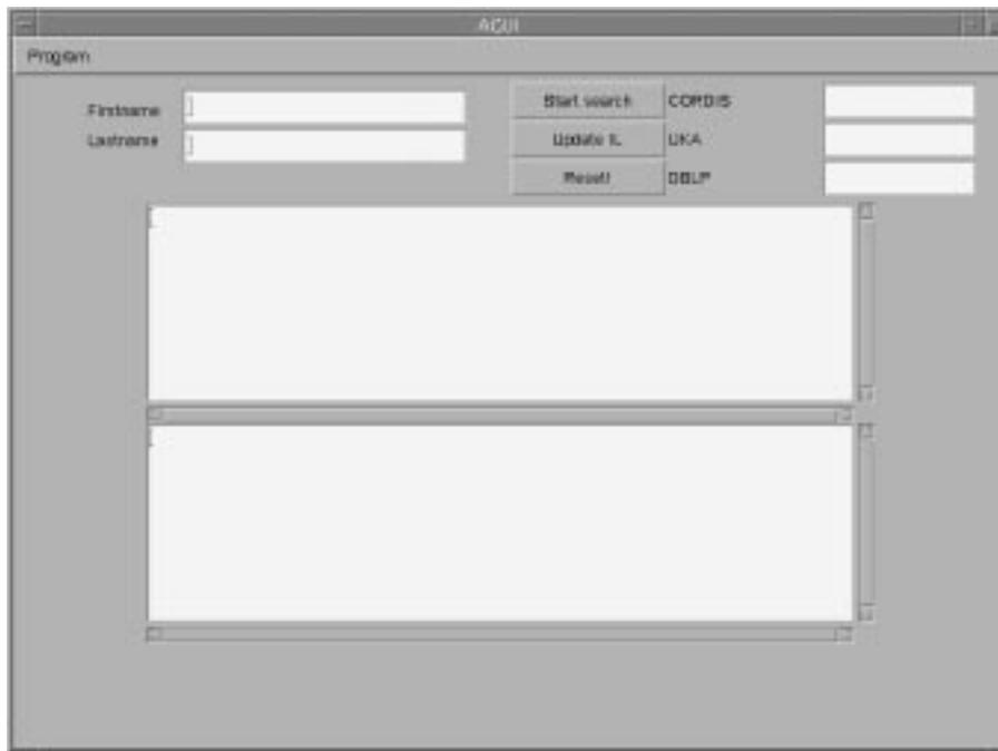
Abbildung A.2: Die Oberfläche des AgentSystemGUI. Links oben befinden sich zwei Textfelder zur Namenseingabe, rechts von der Mitte Funktionsbuttons und auf der rechten Seite die Statusfelder der Agenten, in denen die beschriebenen Meldungen angezeigt werden. Die unteren beiden Textflächen dienen während der Testphase als Protokollanzeigen.
